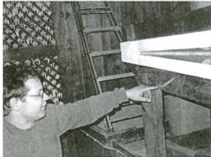
Herr Klaproth von der Orgelbaufirma Rietzsch weist auf Geschößspuren an den Keilbälgen im Inneren der Orgel hin.
