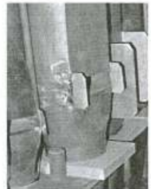
Das ist „Zinnpest“, an dieser Pfeife in einem noch glimpflichen Stadium. Sie ließ sich noch löten.
